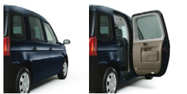
スイング式リヤドア 運転席側のリヤドアにはスイング式を採用 (窓が開かないようになっています)。
