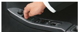
助手席側パワーサイドドア(イージークローザー・ 挟み込み検知機能付/コントロールスイッチ付) 安全性に配慮し、操作中のみドアが開閉 (スイッチを引くとドアが開き、押しと閉ま ります。手を離すとドア開閉停止)。 ■挟まれる物の形状や挟まれ方によっては、挟み込みを検知できない場 合があります。開閉時は十分注意してください。
