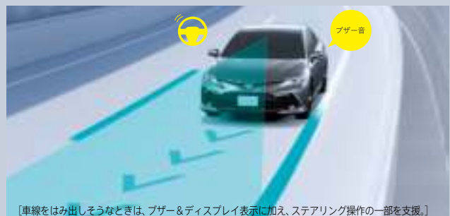
【車線をはみ出しそうなどときは、ブザー&ディスプレイ表示に加え、ステアリング操作の一部を支援。】
