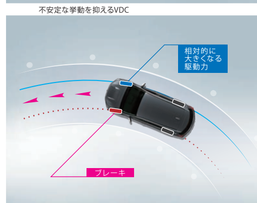
旋回性能を高めるアクティブ・トルク・ベクタリング
