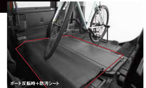
ボード反転時+防汚シート
