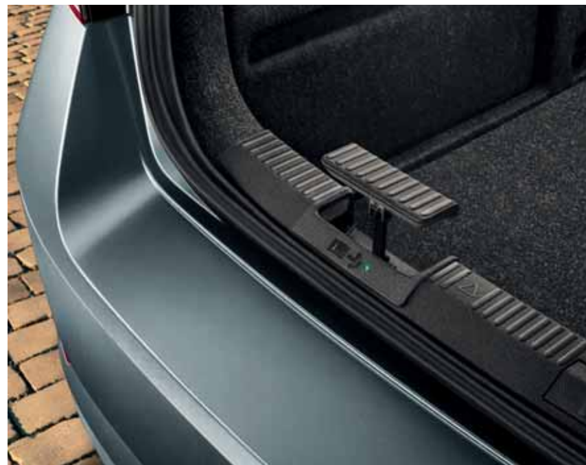
Spak för infällning av dragkroken
