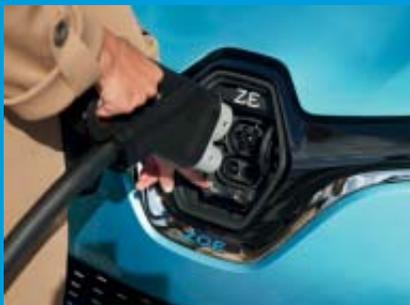
Al conectar tu ZOE para cargarlo, la potencia de carga en kW es máxima cuando la batería está totalmente o casi totalmente descargada. La velocidad de carga disminuye a continuación de manera progresiva a medida que su nivel de carga se aproxima al 100%. La potencia de carga que puedes ver depende de la potencia del terminal, la temperatura y el desgaste de la batería.
