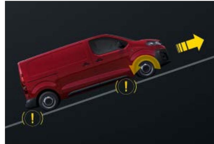
**Asistente de Salida en Cuesta:** Evita que el vehículo retroceda al iniciar la marcha en una pendiente. Para ello mantiene accionados los frenos hasta que pisas el acelerador.
