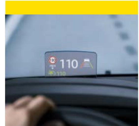
**Head-up Display<sup>2</sup>:** Una solución exclusiva en el segmento. Muestra justo en tu línea de visión información clave, como la velocidad, datos del Control de Crucero Semi-Adaptativo<sup>2</sup> y del Detector de Señales de Velocidad<sup>2</sup>.
