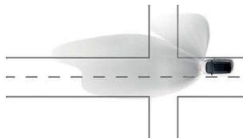
**Luces de Giro<sup>1</sup>.** Eliminan los “agujeros negros” en las intersecciones y curvas a baja velocidad (hasta 40 km/h).
