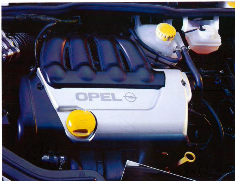
De ECOTEC-1.6-16V-motor van de GSi.
