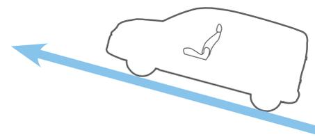
**BERGANFAHR-ASSISTENT.** Um zu verhindern, dass Sie beim Anfahren an einer Steigung nach hinten rollen, hält der Berganfahr-Assistent den Bremsdruck ein paar Sekunden aufrecht, um Ihnen Zeit zu geben, vom Brems- aufs Gaspedal zu wechseln.
