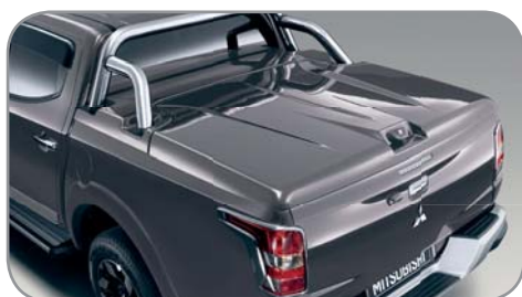
Pevný vyklápěcí kryt ložné plochy
