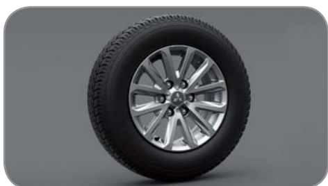
Disky kol z lehkých slitin 17" + pneumatiky 245/65 R17
