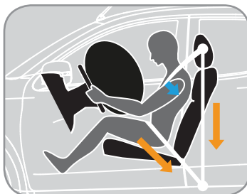
Dvojitě předpínače (sedadlo řidiče)
