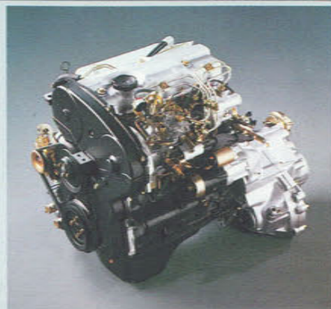
1,8-l-Diesel-Motor mit 2 Ausgleichswellen („silent shafts“)
