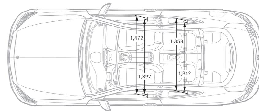
\*所有测量值均以“毫米”为单位。所示尺寸为平均值, 适用于空载的标准车型。尺寸图仅作为数据参考, 车型外观配置以实际销售车辆为准。
