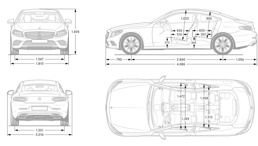
Alle Angaben in Millimetern. Die abgebildeten Maße sind Mittelwerte. Sie gelten für Fahrzeuge in Grundausstattung und in unbelastetem Zustand.
