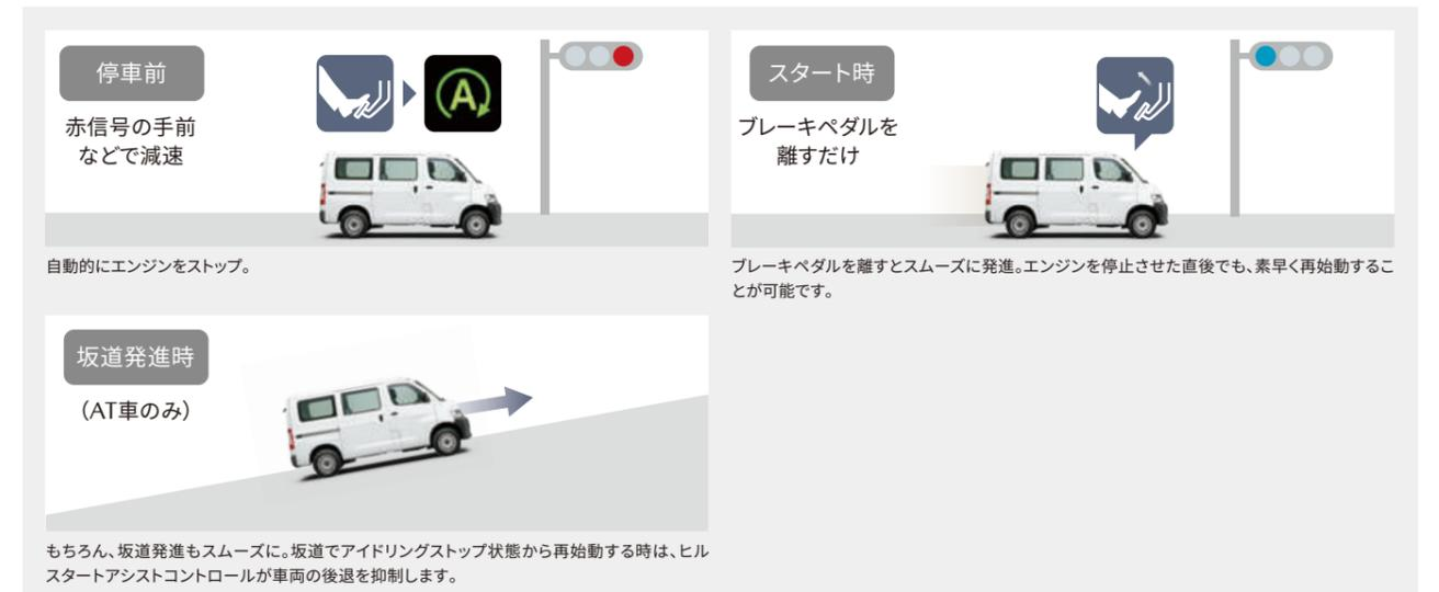
※5 シフトがDポジションの状態です。ブレーキペダルを踏み、車速約9km/h以下になるとエンジンが自動的に停止します(エンジン停止には、いくつかの条件があります。詳しくは販売会社におたずねください)。
