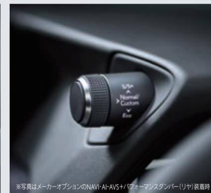
ドライブモードセレクトスイッチ 複数のシステムを統合的に制御。Sportモード、Ecoモードなど、ドライバーの好みやさまざまな走行シーンに応じてドライブモードを切り替えることで、さらなる走りの楽しさを提供します。
