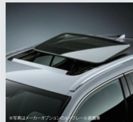
ムーンルーフ(チルト&アウトースライド式) 室内からの開放感を高める搭載位置や、開口時の風切り音を低減させるための形状を実現しています。
