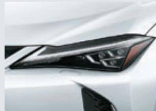
三眼フルLEDヘッドランプ(ロー・ハイビーム)& LEDフロントターニングランプ+アダプティブハイビームシステム[AHS]+ヘッドランプクリーナー
