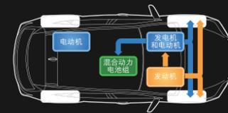
车辆起步时，混合动力电池组向电动机提供动力。此时，电动机单独工作，让车辆拥有出色而宁静的加速表现，不产生任何油耗。
