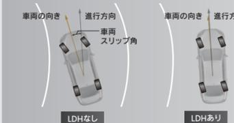
一般的に車速が増すと車両は内側を向く傾向がありますが、LDH装着車は車両の向きを進行方向に限りなく近づけることで、高速旋回時の思い通りの車両応答性を実現。
