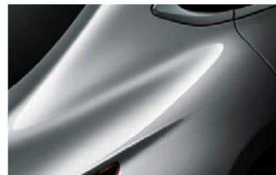
銀影ラスターの実現は、ソニック工法という塗装技術を確立できたことにあります。ソニック工法とは塗料の体積を凝縮し薄い膜にすることにより塗料内のアルミフレークを平滑に並べる技術で、反射をより強く表現することが可能になります。銀影ラスターはこのソニック工法を応用し、塗膜を1ミクロンという極めて薄い層に凝縮する技術を開発。蒸着アルミ粒子を高密度で敷き詰めた究極の金属質感を作り出しました。同時に、塗装技術においても肌感の向上を追求する微粒化と
