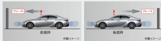
低速走行時に壁などの静止物までの距離と危険度を、マルチインフォメーションディスプレイおよびフロント・リヤブザーなどでお知らせします。低速走行時に壁などの静止物と衝突する可能性が高いと判断した場合、自動(被害軽減)ブレーキをかけます。
