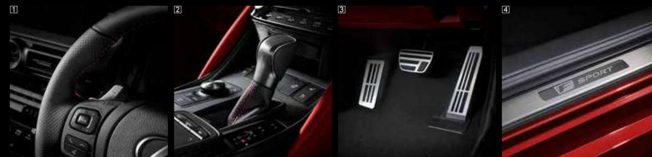
① "F SPORT" 専用ティンクル本革ステアリング(パドルシフト付) ② "F SPORT" 専用ティンクル本革シフトノブ ③ "F SPORT" 専用アルミ製スポーツペダル&フットレスト ④ "F SPORT" 専用スカッフプレート(フロント: ステンレス["F SPORT" ロゴ])
