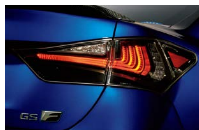
フルLEDリヤコンビネーションランプ(テール・ストップ・バックアップ・ターンシグナル)
