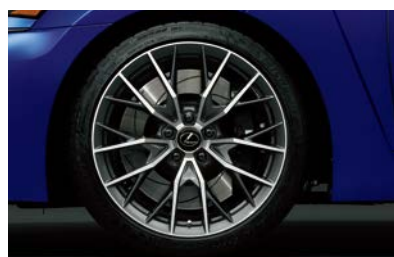
フロント255/35ZR19+リヤ275/35ZR19タイヤ&鍛造アルミホイール(BBS製・ポリッシュ仕上げ・10本メッシュスポーク)
