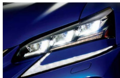
三眼フルLEDヘッドランプ(ロー・ハイビーム)&LEDフロントターンシグナルランプ/LEDクリアランスランプ(デイルイト機能付)
