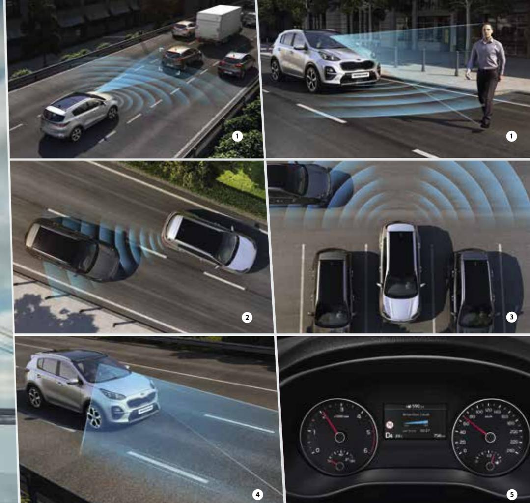
1. **Système de freinage autonome (FCA)**<sup>(1)</sup> A l'aide d'un radar et d'une caméra, ce système est capable de détecter un risque de collision avec un piéton ou avec le véhicule qui vous précède. Sans réaction du conducteur après émission de l'alerte sonore, le système freine automatiquement afin d'éviter l'accident, ou en diminuer l'impact.
