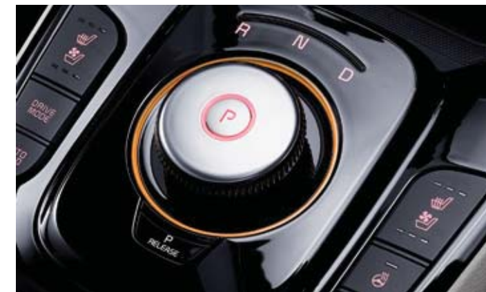
다이얼식 SBW 변속기와 다이얼 SBW가 전자통신으로 작동하는 시스템으로, 진동이 없고 작은 조작력과 동선만으로 변속이 가능하여 편의성이 뛰어납니다. ※ 6가지 컬러 구현
