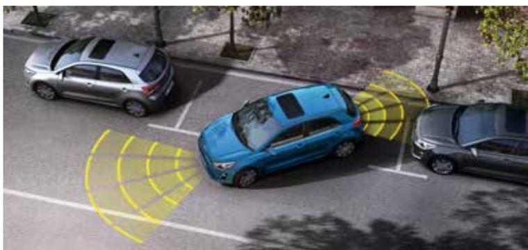
**Sensores de aparcamiento delanteros y traseros.** Ideal para aparcarse con confianza, el sistema utiliza sensores integrados en los paragolpes delantero y trasero, para advertir de cualquier obstáculo cuando maniobras (equipamiento según versiones).
