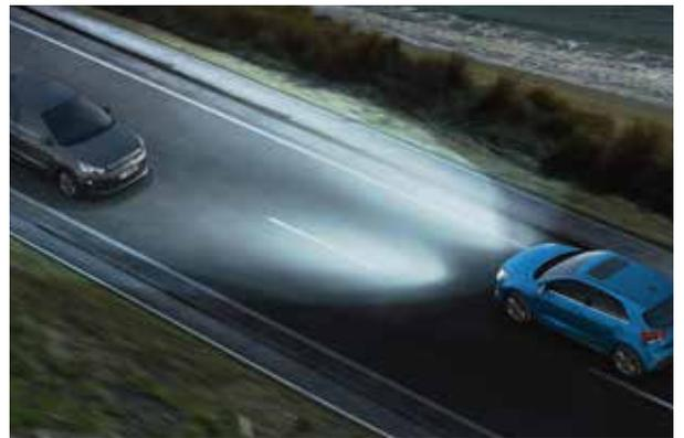
**Asistente dinámico para luces de carretera.** La cámara integrada en el parabrisas detecta los vehículos que vienen en dirección contraria por la noche y cambia automáticamente a una luz de cruce para evitar deslumbrar a los demás conductores (equipamiento según versiones).
