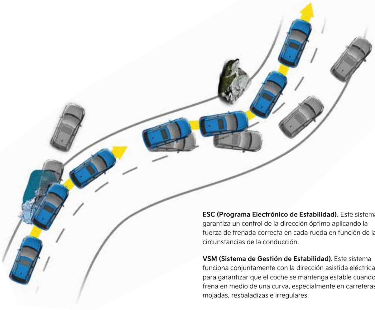
**ESC (Programa Electrónico de Estabilidad).** Este sistema garantiza un control de la dirección óptimo aplicando la fuerza de frenada correcta en cada rueda en función de las circunstancias de la conducción.
