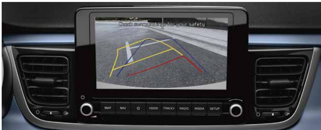
**Navegador UVO Connect con pantalla de 20 cm (8") TFT-LCD**. Dispón siempre de una visión clara al dar marcha atrás para estacionar tu vehículo gracias a la cámara de asistencia al estacionamiento.
