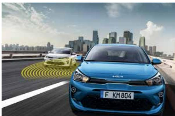
**Sistema de detección de ángulo muerto (BCW)**. Cuando quieres cambiar de carril, el sistema detecta cualquier vehículo en el punto muerto y te avisa con un símbolo de advertencia en el espejo lateral y en la pantalla, además de una señal acústica (equipamiento según versiones).
