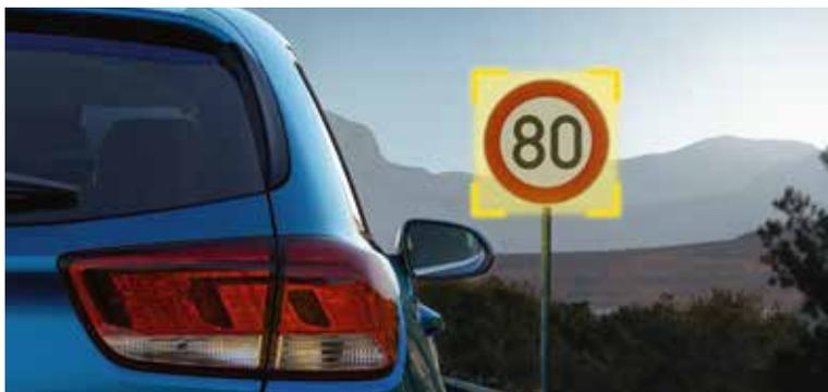
**Sistema de reconocimiento de límites de velocidad (ISLW).** Este sistema te da toda la información necesaria para ayudarte a mantenerte dentro de los límites de velocidad. Utilizando la cámara del parabrisas, lee los límites de velocidad, y muestra la información con claridad en la pantalla para que puedas tomar las medidas necesarias (equipamiento según versiones).
