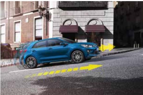
**HAC (Sistema de ayuda de arranque en pendiente).** Cuando arrancas en una pendiente fuerte, este sistema mejora el agarre y mantiene retenido el vehículo un par de segundos para dar tiempo a pisar el acelerador.
