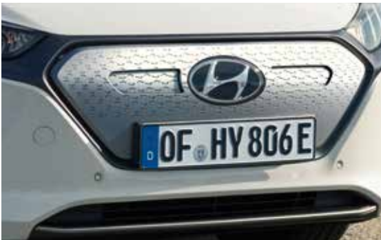
Im Kühlergrill integrierte Lüftungseinlässe schließen sich automatisch und optimieren die Aerodynamik beim IONIQ Elektro.
