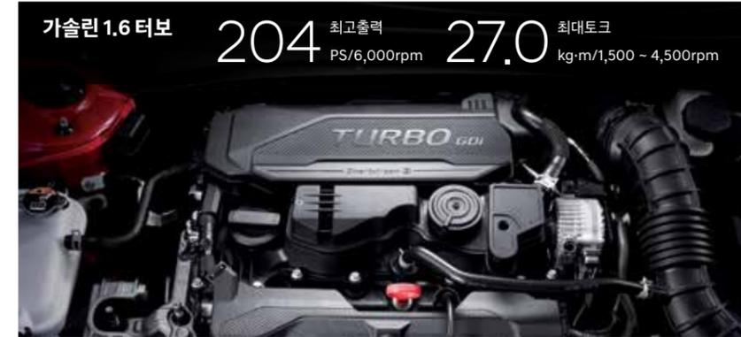
가솔린 1.6 터보 204 최고출력 PS/6,000rpm 27.0 최대토크 kg·m/1,500 ~ 4,500rpm
