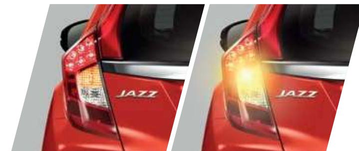
Emergency Stop Signal (ESS) สัญญาณไฟฉุกเฉินอัตโนมัติขณะเบรกกระทันหัน
