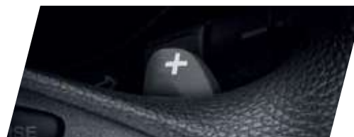
ระบบควบคุมการเปลี่ยนเกียร์ ที่พวงมาลัยแบบ 7 สปีด (7-speed Paddle Shift)
