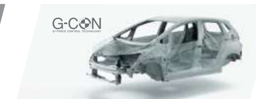
G-Force Control (G-CON) โครงสร้างตัวถังถึงนิรภัยปกป้องห้องโดยสารจากการชนรอบทิศทาง
