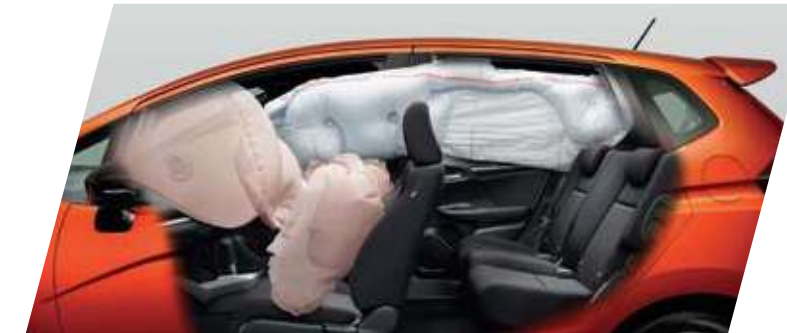
ระบบถุงลม 6 ตำแหน่ง ถุงลมคู่หน้า Dual SRS ถุงลมด้านข้างคู่หน้าแบบอัจฉริยะ: i-Side Airbags และหมอนถุงลมด้านข้าง Side Curtain Airbags
