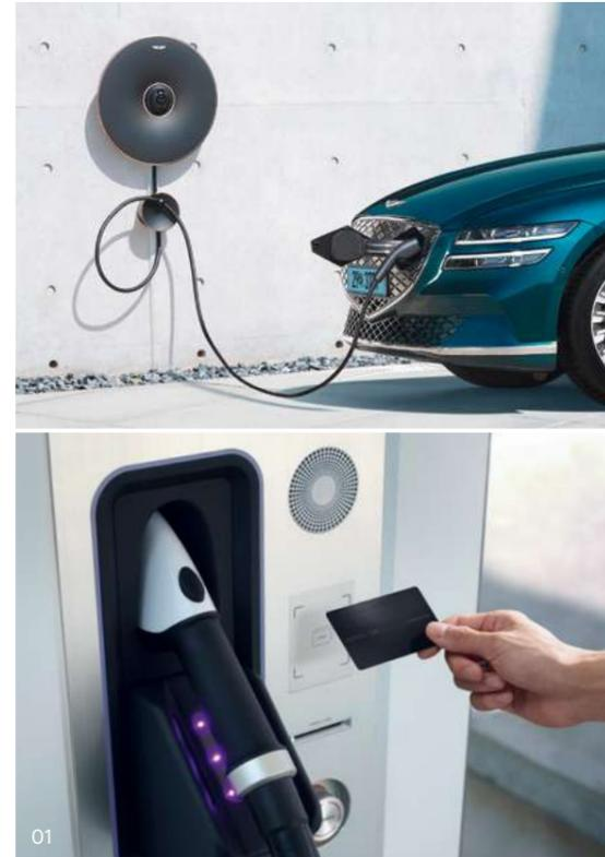
**02. 03. 완속 충전 & 멀티입력 충전시스템(400V/800V 겸용)** \_ 완속 충전과 일반 급속 충전기, 초급속 충전기를 모두 지원하는 400V/800V 멀티입력 충전시스템을 적용하였습니다.
