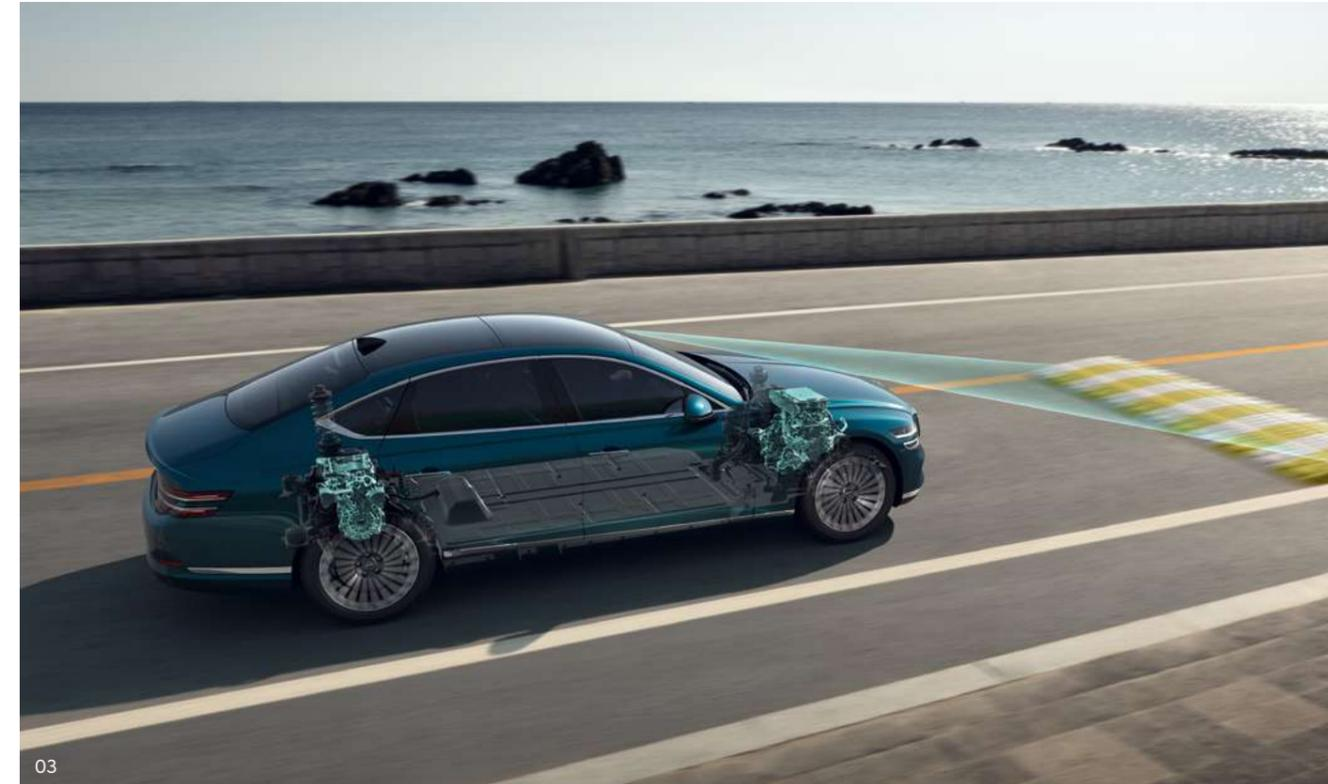
**프리뷰 전자제어 서스펜션** \_ 전방 카메라로 인식한 노면 정보와 내비게이션의 지도 정보를 바탕으로, 서스펜션의 감쇠력을 자동으로 조절하여 차량의 움직임을 제어합니다. 과속방지턱과 같이 차량에 큰 충격을 줄 수 있는 상황을 미리 인지하고 대응함으로써 부드럽고 편안한 승차감을 제공합니다.
