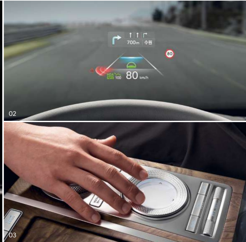
02. 헤드업 디스플레이 _ 주행속도, 내비게이션 정보 등은 물론, 운전자 보조 시스템의 주요 정보들과 갈림길 정보 등을 표시합니다. 12인치 와이드의 고화질 디스플레이로 주-야간 모두 시인성이 뛰어납니다.
