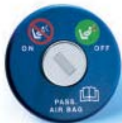
Disattivatore di airbag, per trasportare un seggiolino bimbi sul sedile anteriore.
