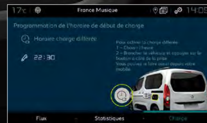
Uitgesteld opladen: om het opladen te plannen op het door u gewenste tijdstip.
