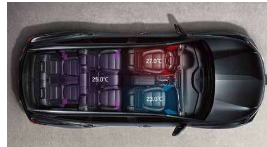
负离子净化三区独立全自动空调系统
