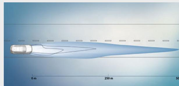
□ La Luz láser BMW con diseño X ilumina en el modo de luz de carretera láser hasta 500 m, prácticamente el doble que los faros convencionales. Gracias a la mejor visibilidad en la oscuridad, se incrementa considerablemente la seguridad. El distintivo "X" en azul y el anagrama "BMW Laser" subrayan la aspiración tecnológica del vehículo.
