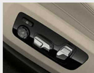
□ El soporte lumbar para los asientos delanteros dispone de reglaje en altura y profundidad, lo que permite mantener una correcta postura ergonómica.
