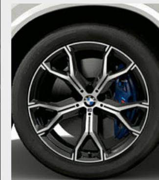
□ Llantas de aleación ligera M de 21 pulgadas con radios en Y estilo 741 M, en bicolor Orbitgrau, con pulido brillante, neumáticos de distintas medidas, delante 9,5 J x 21, neumáticos 275/40 R 21, detrás 10,5 J x 21, neumáticos 315/35 R 21.
