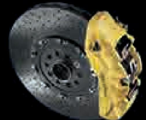
BREMBO® perforierte Kohlefaser-Keramik-Bremsscheiben (optional) mit gelb lackierte Bremssättel (optional)
