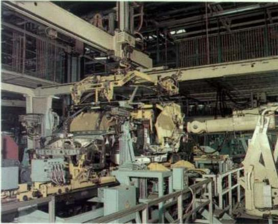
**Der Einsatz von Industrierobotern garantiert absolute Präzision beim Einpassen der Einzelteile. Auf dem Foto zu sehen: Karosserie-Punktschweißanlage**
