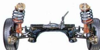
Vorderrad- (oben) und Hinterradaufhängungen (unten) sind Einzelradaufhängungen
