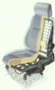
Der Fahrsitz ist so geformt, daß er optimalen Seitenhalt garantiert
