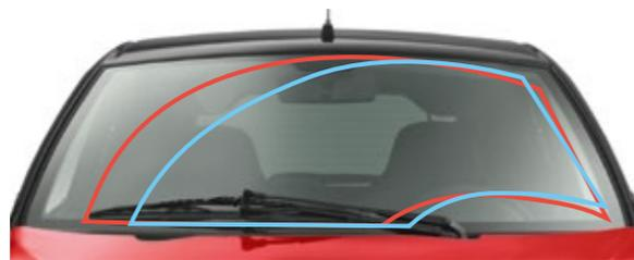
**NOUVEAUTÉ:** Essuie-glace parallélogramme qui permet une plus grande surface de balayage afin de parfaire la visibilité du conducteur et du passager. Le bras est plus long et le mouvement plus précis.
