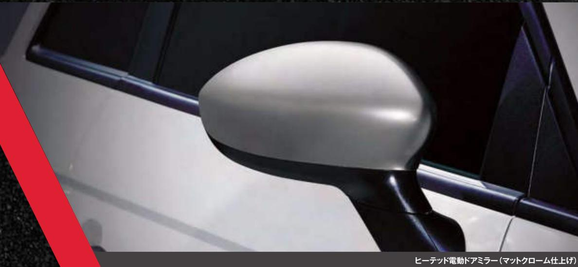
ヒーテッド電動ドアミラー (マットクローム仕上げ)
