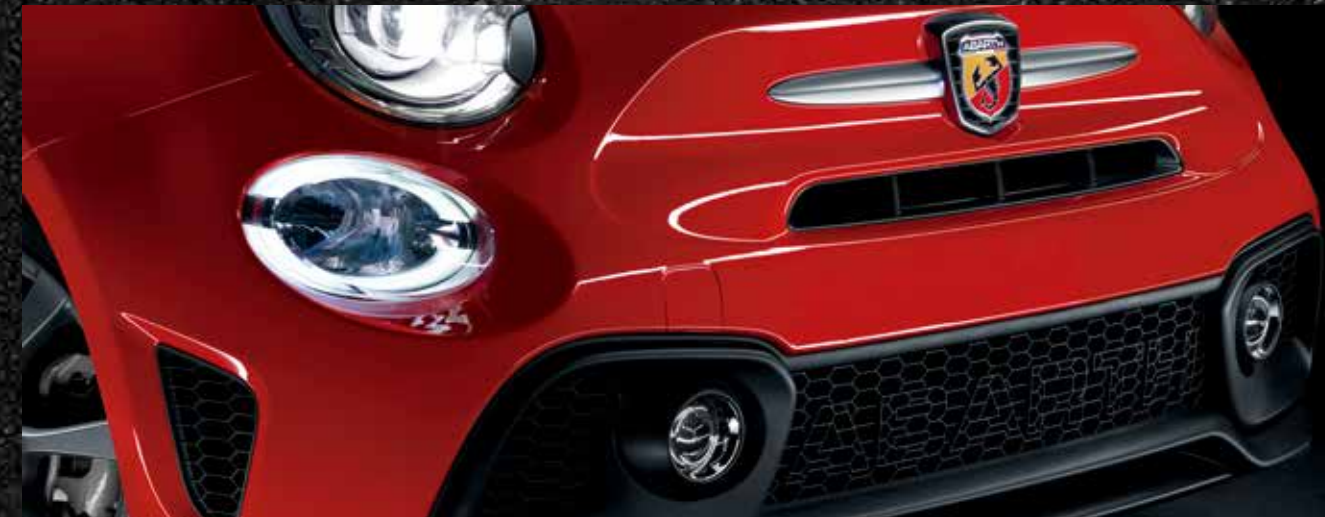
LEDデイランプ、フロントバンパー (インタークーラー冷却用エアインテーク付)
