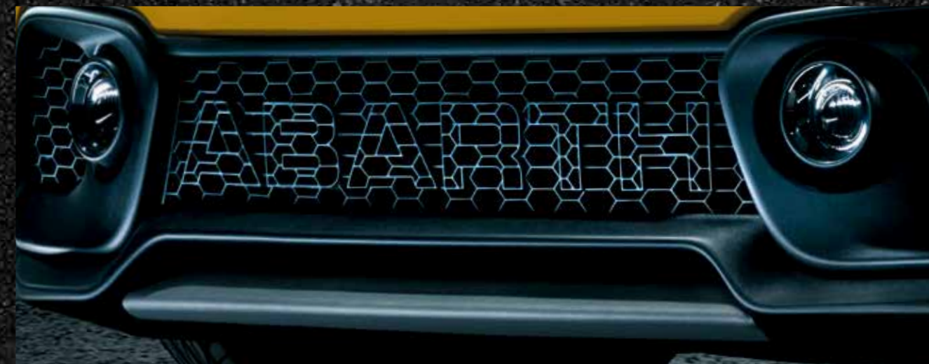
フロントバンパー / ガンメタリック仕上げリップスポイラー(インタークーラー冷却用エアインテーク付)
